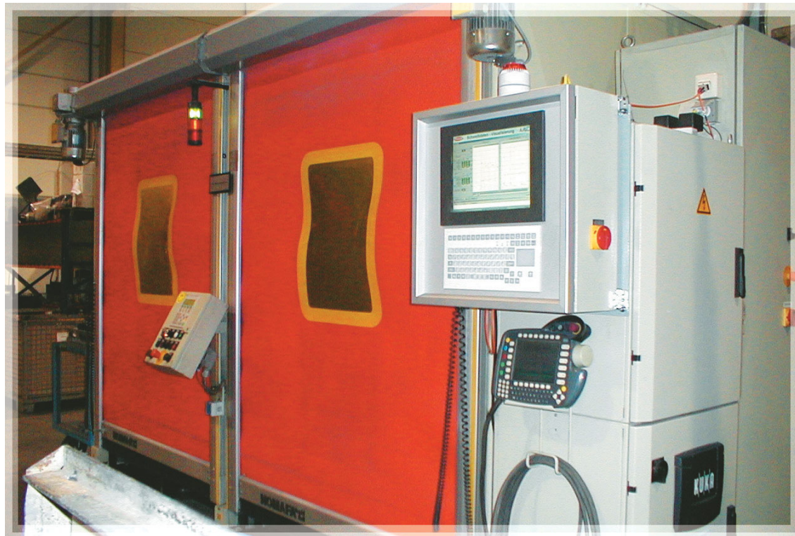
Fertigungsprüfstand zur Überwachung des Schweißprozesses
