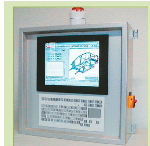
Masterstation zur Überwachung von Schweißprozessparametern
