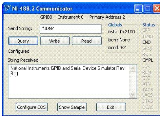
Abbildung 2: Der NI-488.2 Communicator ermöglicht die schnelle Überprüfung der Hardwareverbindung
